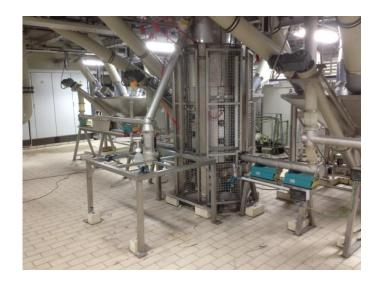
Wendelförderer mit Infrarot-Strahlern
